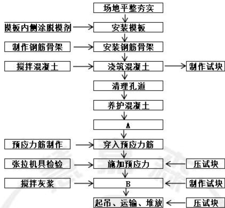
图 1 T 梁施工工艺图
